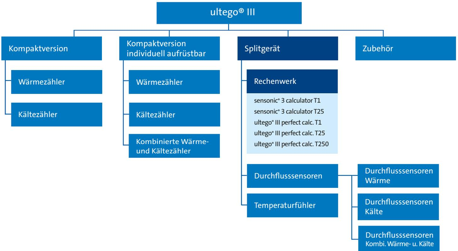
Als Splitgerät lässt sich das Rechenwerk sensonic® 3 calculator mit den verschiedenen Durchflusssensoren des ultego® III flow sensor und mit Temperaturfühlern in zwei verschiedenen Längen kombinieren und ist in zwei verschiedenen Versionen – mit der Impulswertigkeit 1 bzw. 25 Liter pro Impuls – erhältlich. Des Weiteren stehen für den speziellen Einsatz – Erfassung der Energie bei zentralen Warmwasserversorgungsanlagen – die
