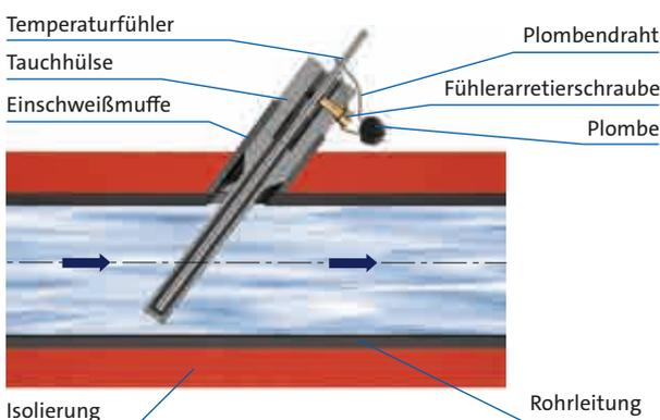
Die Temperaturfühler werden in Pfeilrichtung angeströmt. Die richtige Eintauchtiefe der Temperaturfühler lässt sich mit Hilfe der Auswahltable des Tauchhülsensets genau bestimmen (siehe Seite 30).
