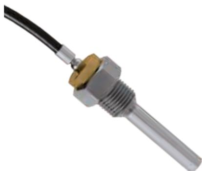
Die Temperaturmessung in Vor- und Rücklauf erfolgt durch Temperaturfühler aus Platin, die höchste Genauigkeit bei der Ermittlung der Temperaturdifferenz garantieren. Bei den kombinierten Wärmehählern sind sie nicht direkt am Rechenwerk angeschlossen, sondern müssen separat bestellt und angeschlossen werden. Die Temperaturfühler stehen in 3 m Länge mit 2-Leiter-Technik und in 10 m und 30 m Länge mit 4-Leiter-Technik zur Verfügung.
