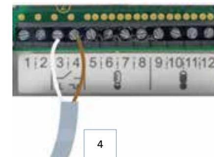
Nell'uscita impulsiva dei volumetrici meccanici è presente un terzo cavo di colore Giallo che non deve essere collegato
