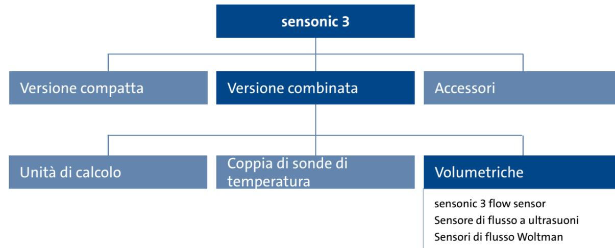
Le unità di calcolo possono essere combinate con diverse volumetriche: sononic 3 flow sensor, sensori di flusso a ultrasuoni o sensori di flusso Woltman.
