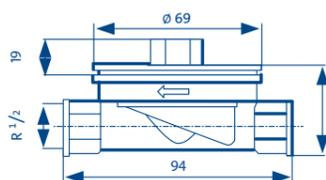
EAS con filettatura esterna e apertura per sonda di temperatura\*
