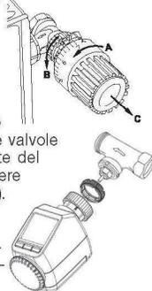
Alcune valvole richiedono l'utilizzo di un adattatore. Gli adattatori per le valvole Danfoss (RA, RAV, RAVL) fanno parte del volume di fornitura. Per i dettagli vedere la tabella adattatori (vedi paragrafo 21).
