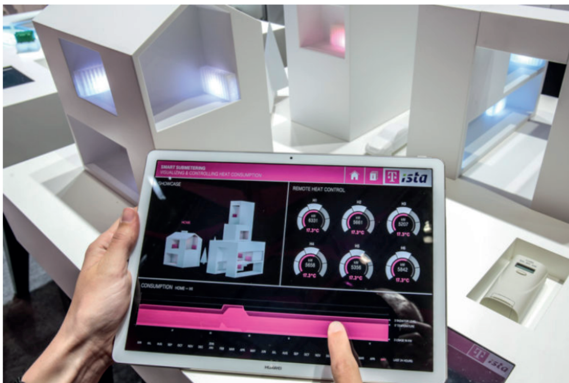
La app "ista connect" permette di controllare sul proprio dispositivo mobile i consumi di acqua calda, calore ed acqua fredda comparati con la media del condominio
