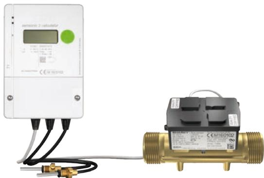
La volumetrica del contatore ad ultrasuoni è in ottone, senza parti in movimento. Due opposti trasduttori, di invio e di ricezione, inoltrano segnali a ultrasuoni alternativamente con e contro la direzione del flusso dell'acqua. Misurando con esattezza la differenza tra i due tempi di transito, si possono calcolare la velocità del flusso e quindi la portata ed il volume. Un impulso proporzionale al volume inoltra poi queste informazioni all'unità di calcolo collegata.
