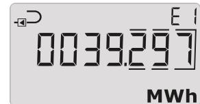
MULTICAL® 403 lucrează cu mai multe registre de energie. Toate tipurile de energie sunt calculate și pot fi afisate conform configurației alese. Atât pe ecran cât și în timpul citirii, fiecare energie este definită unic.
