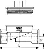
Выпускаются элементы EAS с внутренней и внешней резьбой, а также для соединения пайкой.
