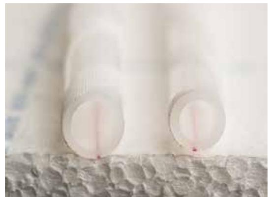
Figura 6.32 Poliestireno extruido y poliestireno expandido.
