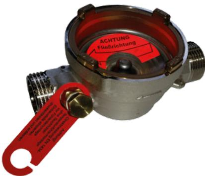
Das Einbauteil für UltraMaXX kann sowohl horizontal als auch vertikal in die Rücklauf-Rohrleitungen eingebaut werden. Es bleibt dauerhaft mit der Installation verbunden. Der Rücklauftemperaturfühler kann im Einbauteil montiert werden. Vor dem Einbau oder nach dem Ausbau wird statt des Wärmezählers die Überströmkappe montiert. So lässt sich ein Abdrücken oder Spülen der Rohrleitungen problemlos durchführen.
