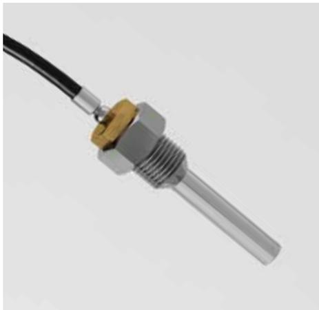
Die Temperaturmessung in Vor- und Rücklauf erfolgt durch Temperaturfühler aus Platin, die höchste Genauigkeit bei der Ermittlung der Temperaturdifferenz garantieren. Bei den kombinierten Wärmezählern sind sie nicht direkt am Rechenwerk angeschlossen, sondern müssen separat bestellt und angeschlossen werden. Die Temperaturfühler stehen in 3 m Länge mit 2-Leiter-Technik und in 10 m Länge mit 4-Leiter-Technik zur Verfügung.
