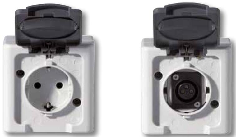
Als Alternative zum Level-Converter LC 250 kann die Connect-Box zur mobilen Auslesung genutzt werden. Die Kombination aus Schutzkontakt-Steckdose und der dreipoligen Inline-Steckverbindungsdose dient zur Spannungsversorgung und zur Ankopplung eines mobilen Level-Converters an das vorhandene M-Bus-Netz im Gebäude. Somit können die Vorteile der zentralen Auslesung über M-Bus genutzt werden, ohne dass ein Level-Converter installiert werden muss.
