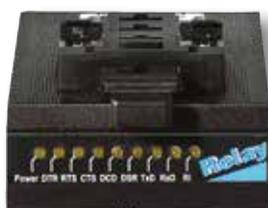
Das LC-250-Modem ist speziell für den Datenaustausch mit dem PC-Modem ausgelegt. Wie das PC-Modem ermöglicht auch das LC-250-Modem eine echte 11-Bit-Datenkommunikation über die normale, analoge Telefonleitung.
