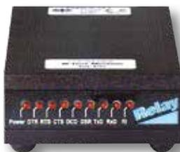
Das PC-Modem ermöglicht in Verbindung mit dem Modem des LC 250 für den Level-Converter einen echten 11-Bit-Datentransfer über die analoge Telefonleitung. Die Übertragung wird
