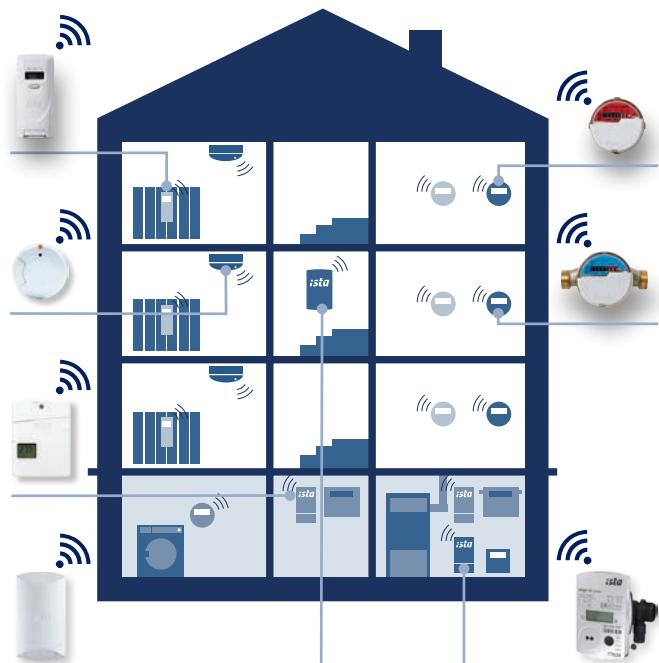
Eksempel på radiobaseret målersystem.
