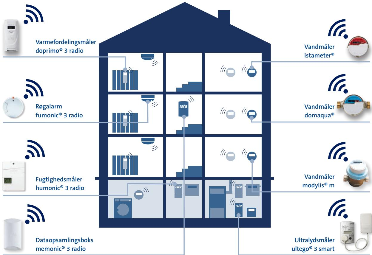
symphonic® sensor net gør det muligt automatisk at få aflæst både vand, varme, energi og el – privat som erhverv – i ét og samme system. Det hele sker 100% trådløst. Systemet består af batteridrevne målere, der kan fjernaflæses af ista. Det giver præcise forbrugsregnskaber og hurtig levering, helt uden at beboere eller administrator behøver at foretage sig noget.
